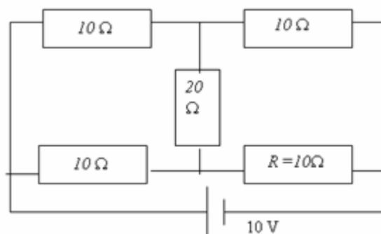
Nous voyons bien qu'il s'agit d'un montage en pont de Wheatstone qui fait que, vu la répartition des résistances de  $10 \text{ } [\Omega]$ , le courant dans  $R$  est nul, car il n'y a pas de différence de potentiel entre ses extrémités (cette résistance ne sert donc à rien).
